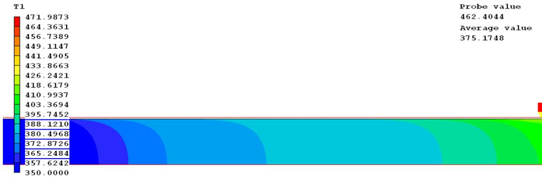
SCWF (LEVEL) : G=1000kg/m2s ; q=681kW/m2
