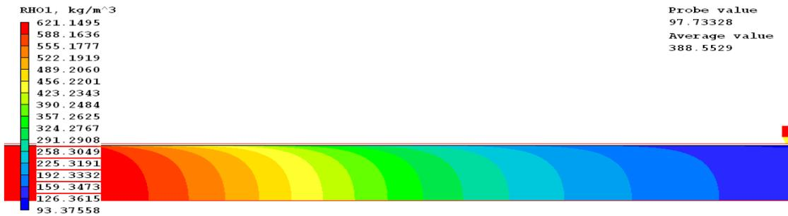
SCWF (LEVEL) : G=1000kg/m2s ; q=681kW/m2
