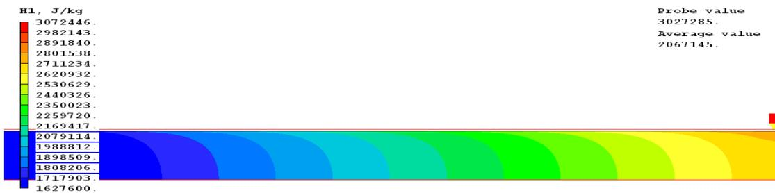
SCWF (LEVEL) : G=1000kg/m2s : q=681kW/m2
